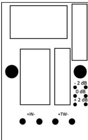
Для регулировки уровня твитера установите переключку напротив соответствующего значения: - 2 dB / 0 dB / + 2 dB.
