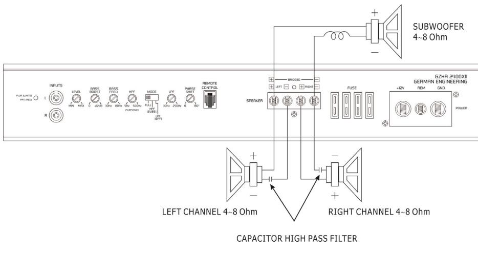
—∞— Spule / Inductor / Filtre Pass bas / Spoel Lowpass Filter
